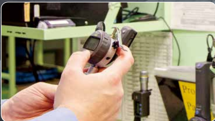
Inspeção sendo realizada no local da produção. Técnicas de amostragem baseadas na Capabilidade do processo reduzem o tempo gasto na inspeção, sem perder a Qualidade dos produtos.
